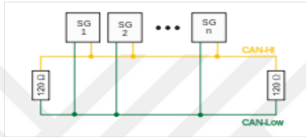
Şekil 10 Sonlandırıcı dirençli CAN bus elektriksel bağlantı örnek topolojisi
