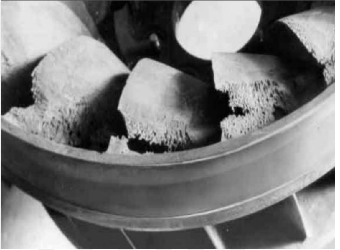
Şekil 23 Kavitasyon etkisinde kalmış türbin [28]
