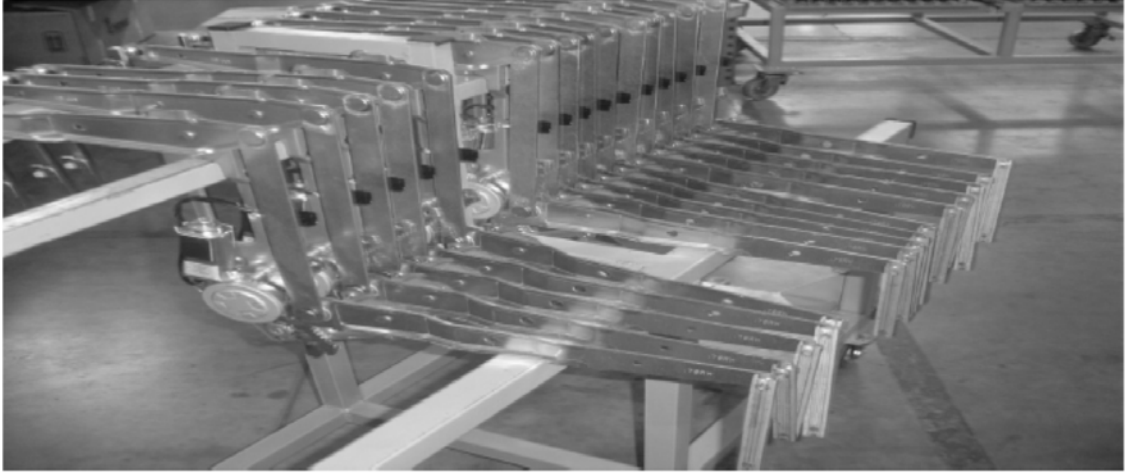
Şekil 16. Sıralı Parçaları için Örnek Bir Dolly
