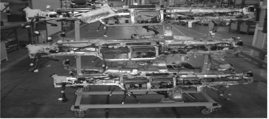
Şekil 15. “Sub-Assembly” Parçalar İçin Örnek Bir Dolly
