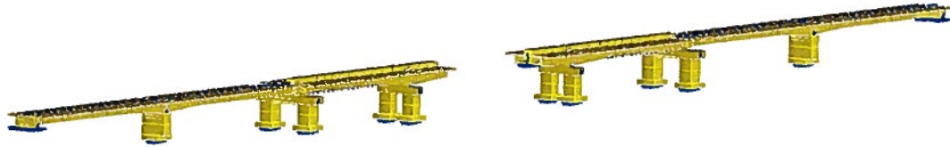
İnşaat Aşaması 3: 3-4 ve 5-6 Aksları arası Üstyapı İmalatı
