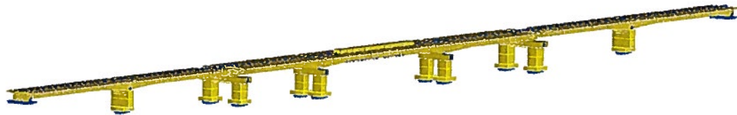
İnşaat Aşaması 3: 3-4 ve 5-6 Aksları arası Üstyapı İmalatı
