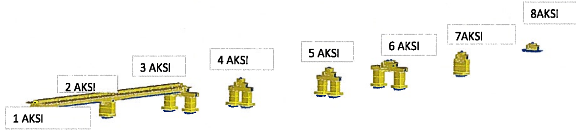
İnşaat Aşaması 1: 1-3 Aksları arası Üstyapı İmalatı
