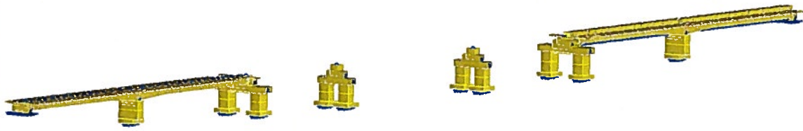
İnşaat Aşaması 2: 6-8 Aksları arası Üstyapı İmalatı
