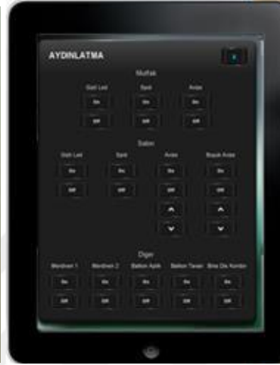
Şekil 19. Aydınlatma Kontrol Paneli (Bal, 2017)
