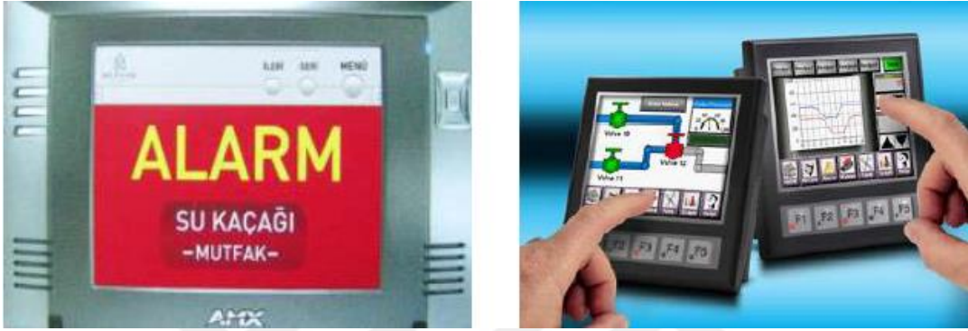
Şekil 29. Su Kaçağını ve Mekanı Gösteren Touch Panel (Aslan 2014)
