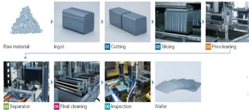
Şekil 35 Wafer Üretim Süreci
