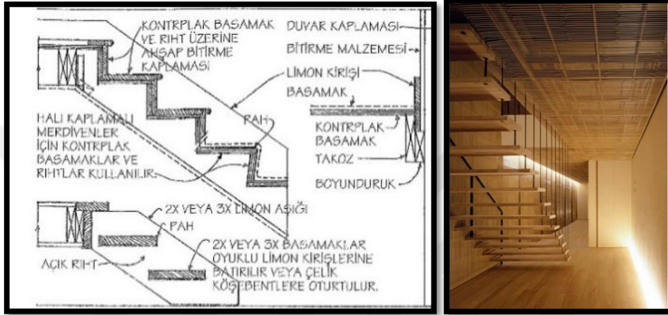
Şekil 8. Ahşap Merdiven Detay ve Örneği (Sol resim: Ching, 2011, Peter 2018)
