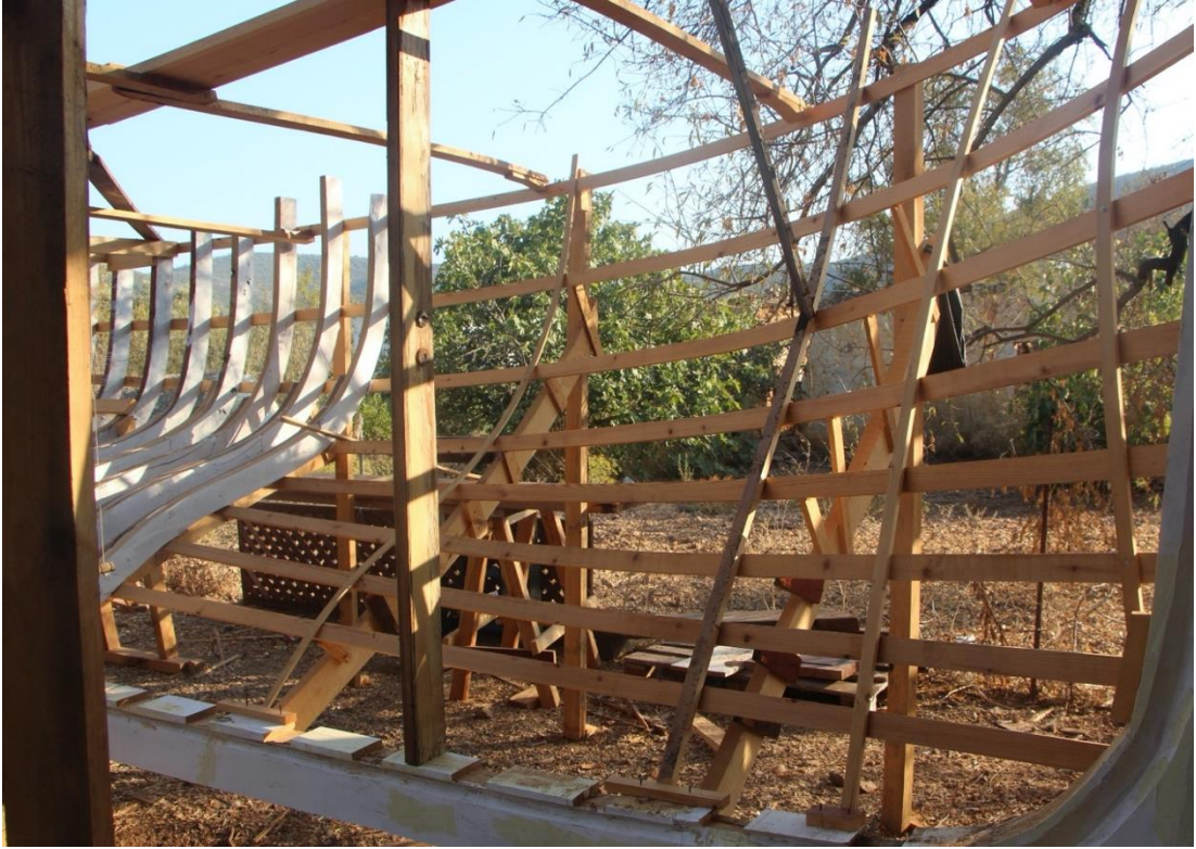
Fotoğraf 12: Yalancı postalar ve yalancı postaların üstüne örülen yan kısımlar, (ince kahverengi çitılar yalancı postalar, beyaza boyanmış olanlar teknenin kalıcı strüktürü, yalancı postalar üretim sonrasında çıkartılacaktır) Yazarın Arşivinden alınmıştır
