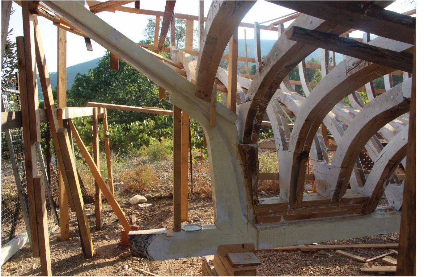
Fotoğraf 32: Baş bodoslama ve omurga geçişi Yazarın arşivinden alınmıştır
