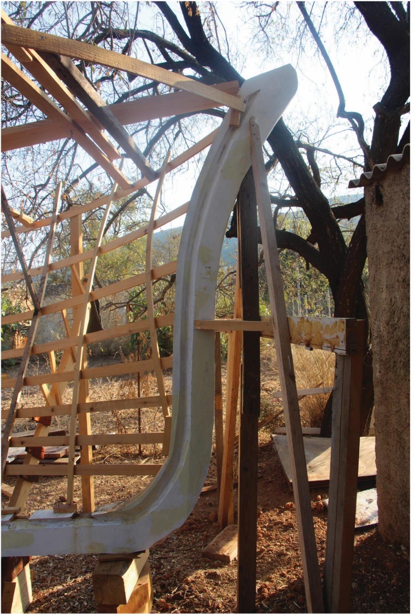
Fotoğraf 30: Yekpare kış bodoslama ve yalancı postalar Yazarın arşivinden alınmıştır
