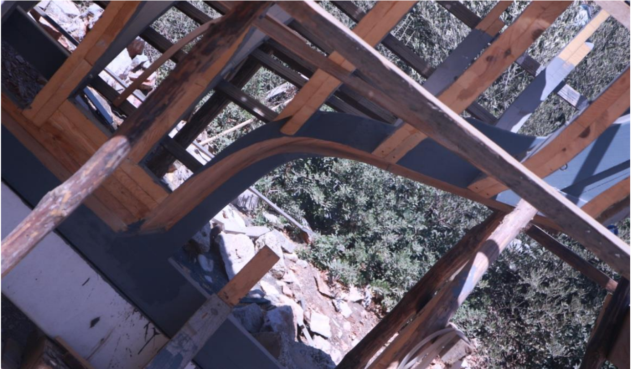
Fotoğraf 6: Tekne arkası su boşluğunun dayanım kısmı, kıç bodoslama Yazarın arşivinden alınmıştır
