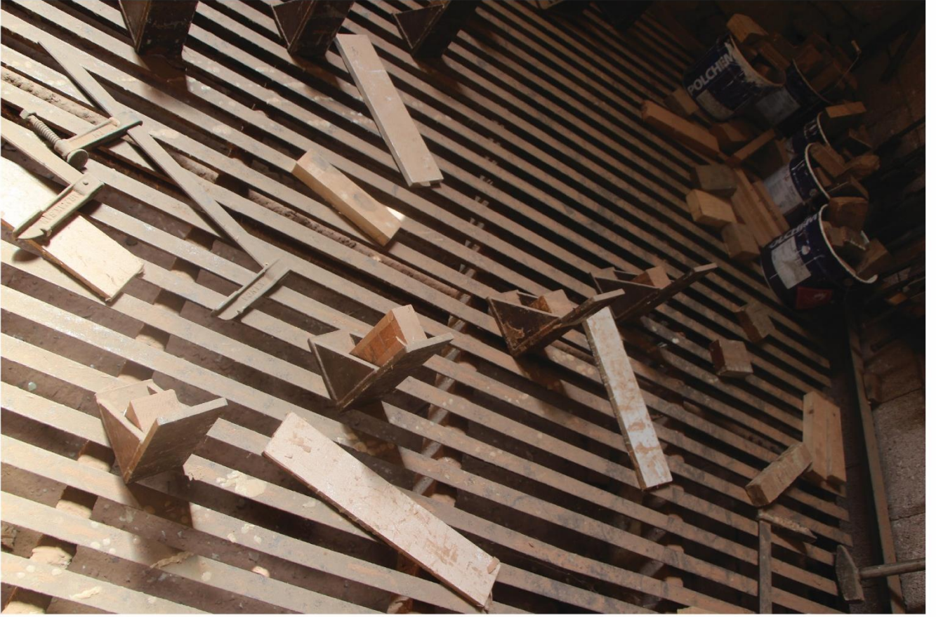
Fotoğraf 38: Biçimlendirme tezgahı detay, işkenceler Yazarın arşivinden alınmıştır
