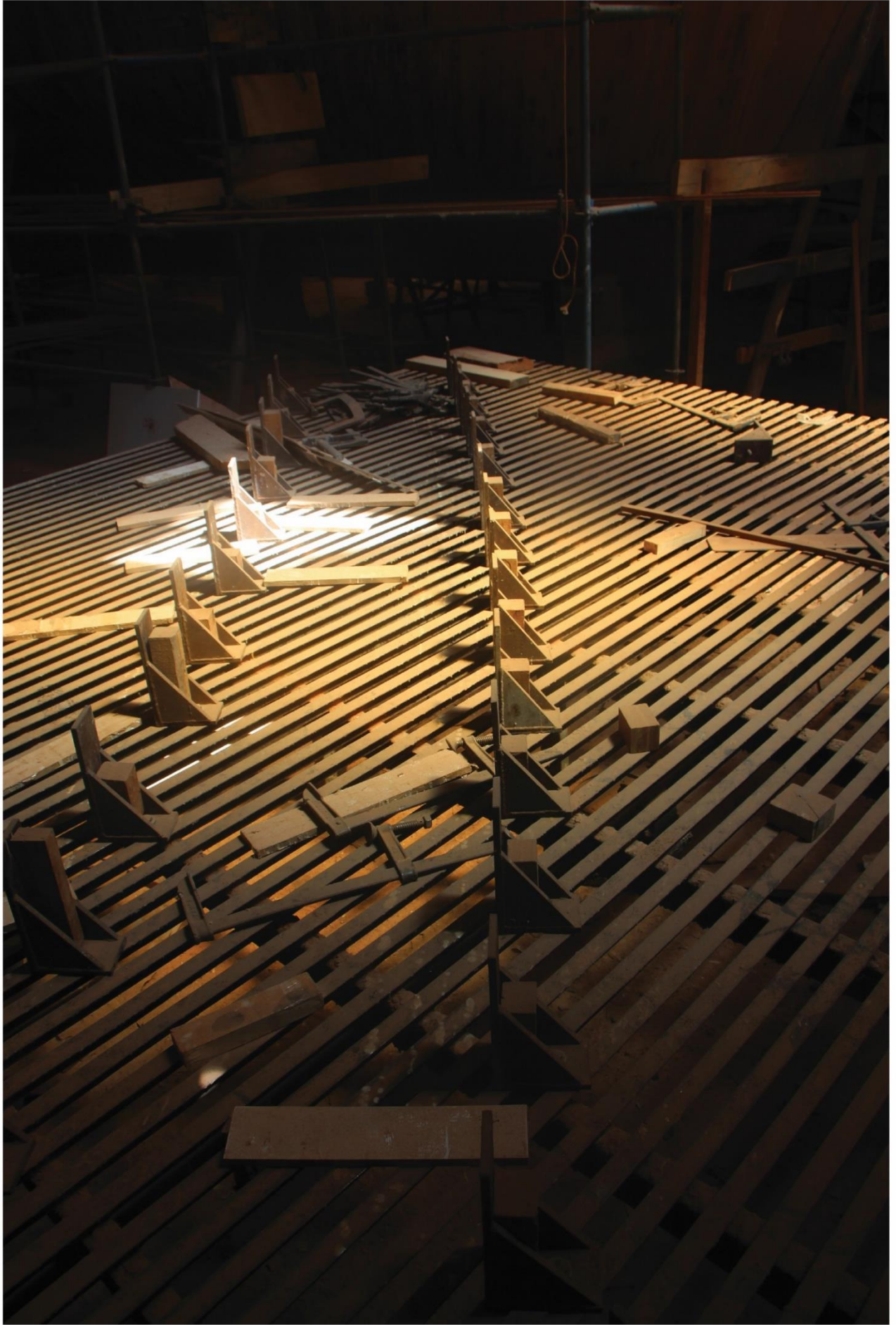
Fotoğraf 37: Biçimlendirme tezgahı, ahşap eğme Yazarın arşivinden alınmıştır
