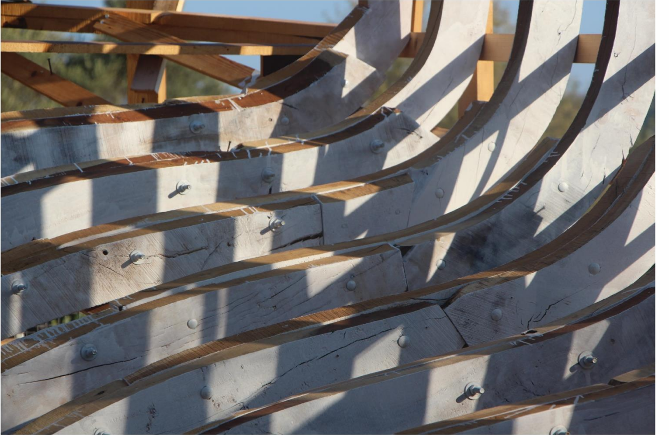
Fotoğraf 34: Baş omurga detayı, bağlantı noktaları Yazarın arşivinden alınmıştır
