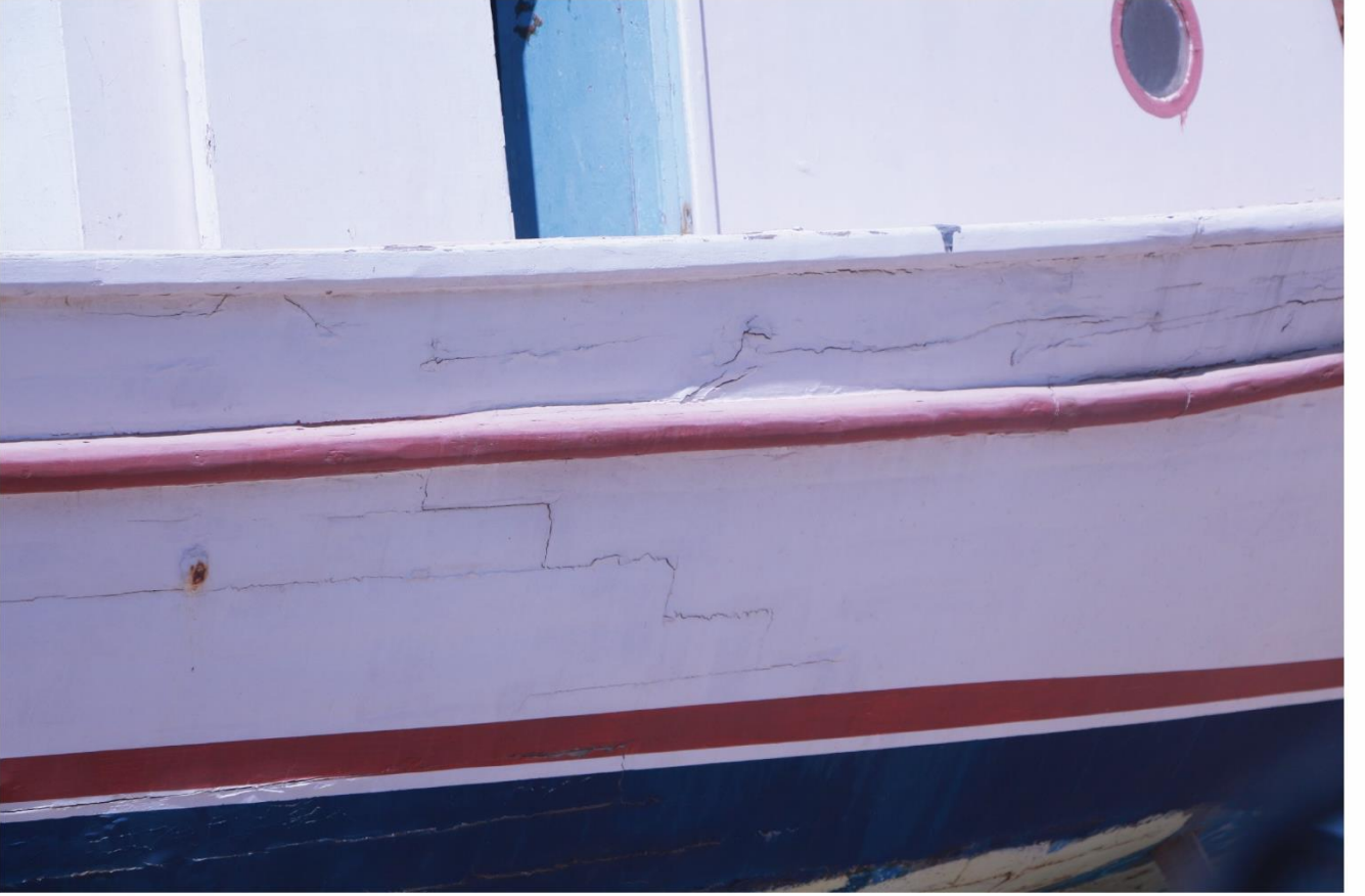
Fotoğraf 53: Konvansiyonel üretim örneđi, kalafat üstü boya çatlaması Yazarın arşivinden alınmıştır
