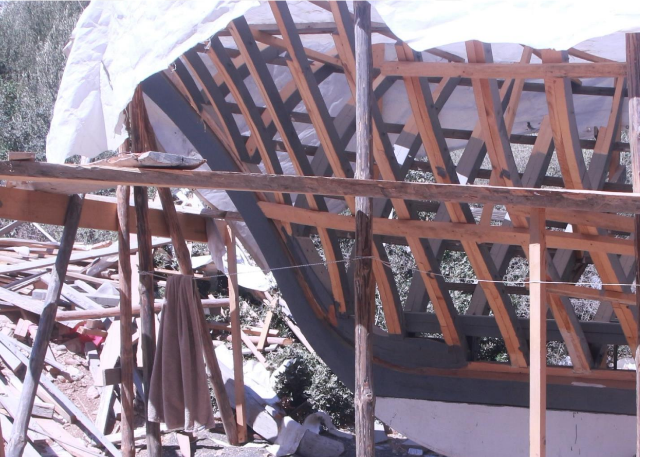
Fotoğraf 3: Yekpare baş bodoslama örneği Yazarın arşivinden alınmıştır
