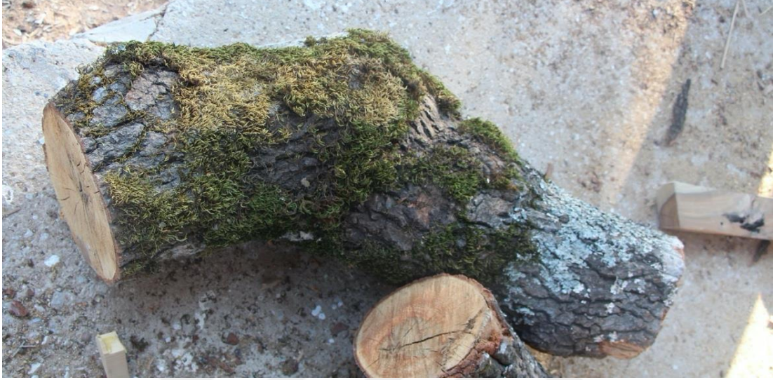
Fotoğraf 11: Bodoslama eğrisi için bulunmuş, formaya uygun ham malzeme örneği Yazarın Arşivinden alınmıştır
