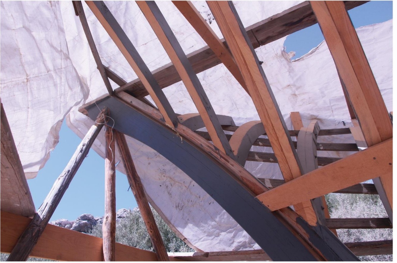
Fotoğraf 59: Bař bodoslama bitiři Yazarın arřivinden alınmıřtır
