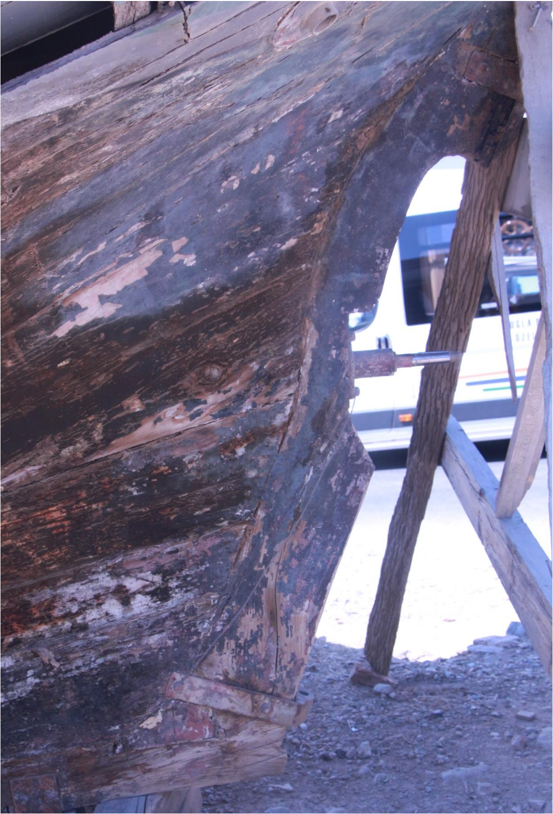
Fotoğraf 7: Yıllar içinde su ile kurulan ilişki sonucunda hasar görmüş baş bodoslama Yazarın arşivinden alınmıştır
