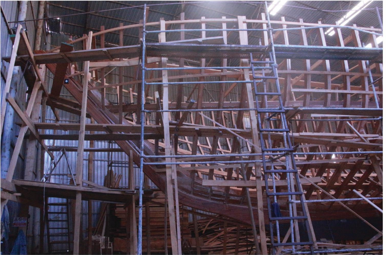
Fotoğraf 56: Atölyeden bir kesit, baş bodoslama, taşıyıcı (geçici) strüktür ve omurga önu Yazarın arşivinden alınmıştır
