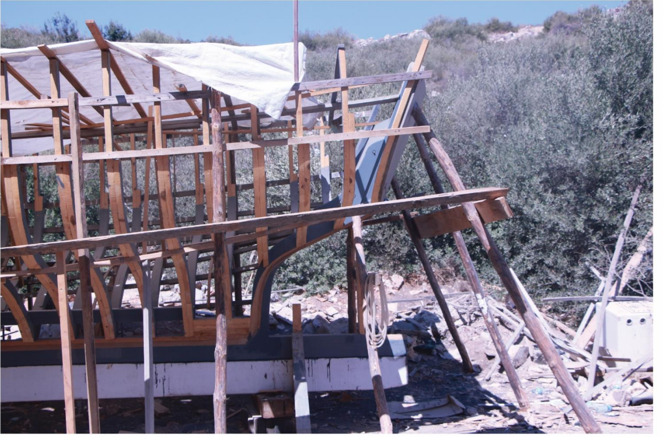
Fotoğraf 57: Kıç bodoslama ve postalar, geçici taşıyıcılar Yazarın arşivinden alınmıştır
