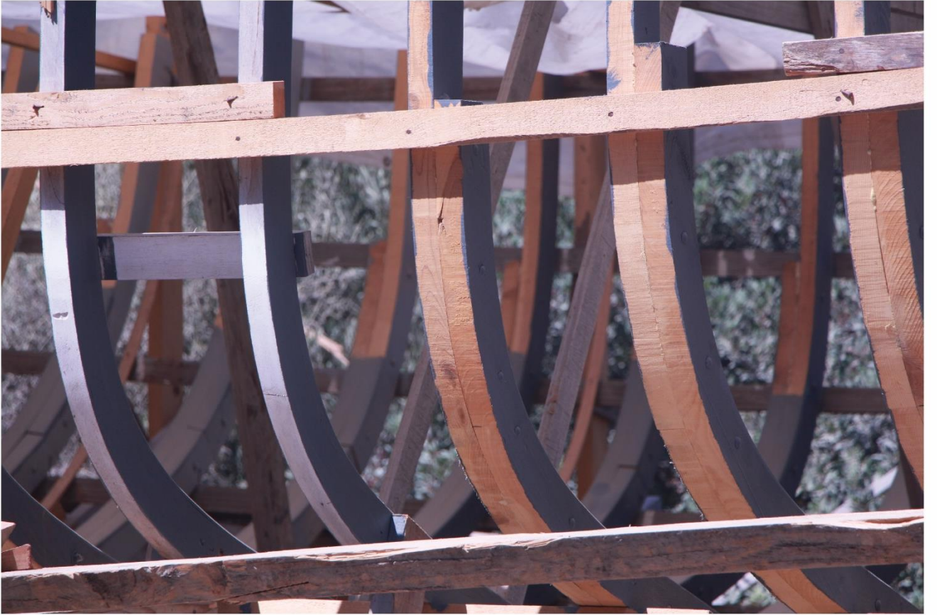
Fotoğraf 62: Omurga detayı ve yalancı postalar Yazarın arşivinden alınmıştır
