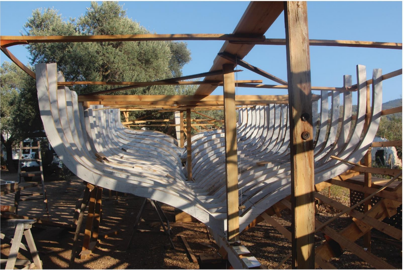
Fotoğraf 35: Omurgas sistemi(tamamlanmamış), arkadař görünüş Yazarın arřivinden alınmıřtır
