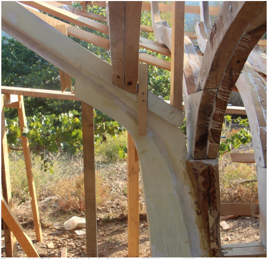
Fotoğraf 4: Çok parçalı baş bodoslama örneği (yanda) Yazarın arşivinden alınmıştır
