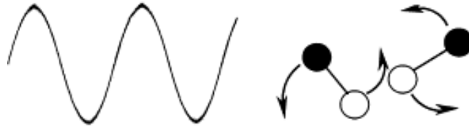
Şekil 1.4.5. Dipolar moleküllerin, salınan bir elektrik alan ile hizalanmaya çalışması
