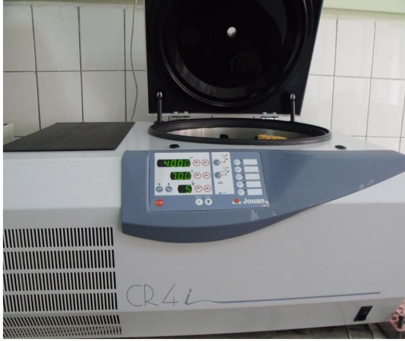
Resim-1: Jouan marka CR4i seri santrifüj cihazı
