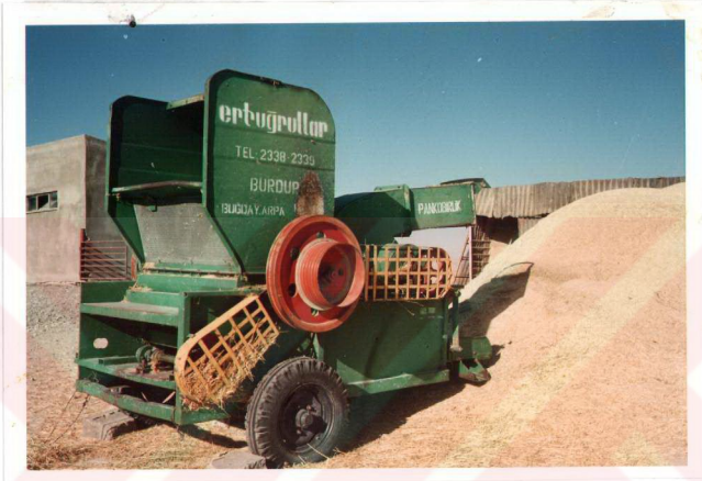
Şekil 3.1. Tohumluk korunga harmanı denemesinde kullanılan sapdöver harman makinası
