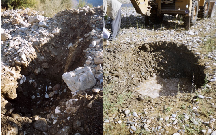
Şekil 4.14. Aydınlık Çayı içerisinde açılan araştırma çukurları.
