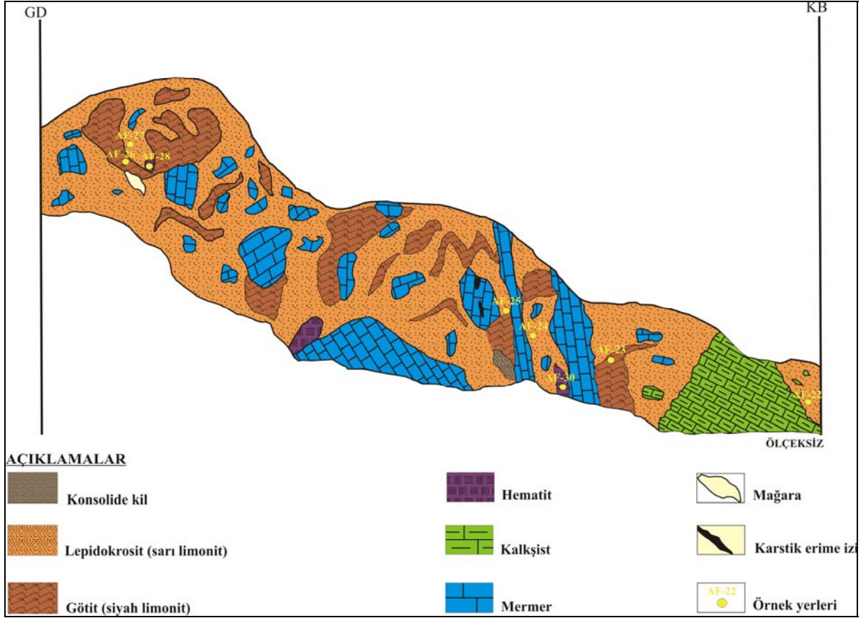
Şekil 4.58. Limonitik zonda görülen karstlaşma izleri ve buradan alınan örneklerin yerleri.
