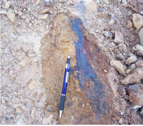
Şekil 4.45. Yankayaçtaki kırık-çatlaklar boyunca gözlenen hematit damarcıkları.
