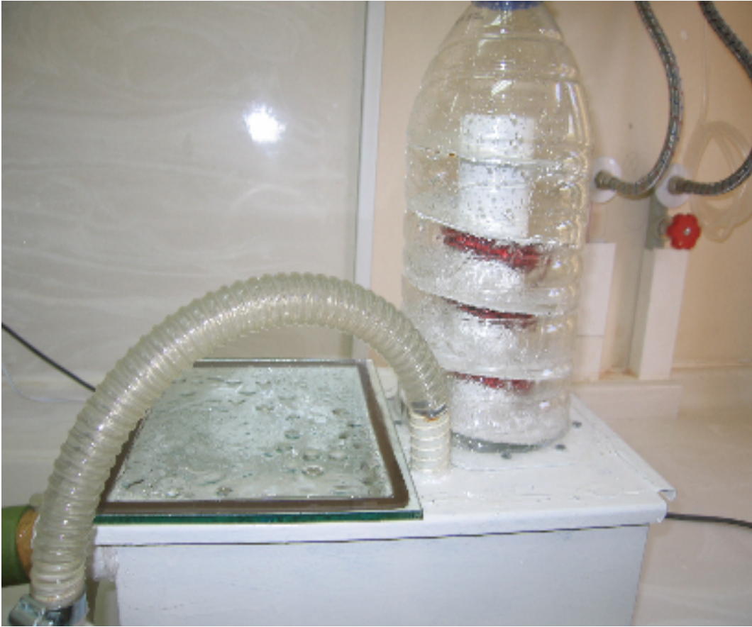
Şekil 4.1. Prototip helezonik tip su yıkamalı hava filtresinin çalışma sırasındaki görünümü.
