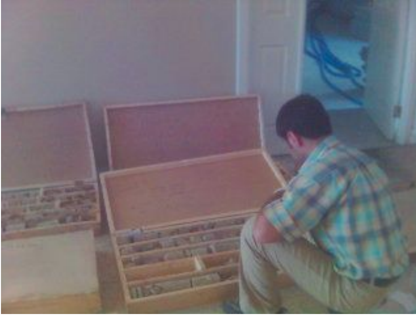
Şekil 3.1. Sondaj karotlarından örnek alma işlemi
