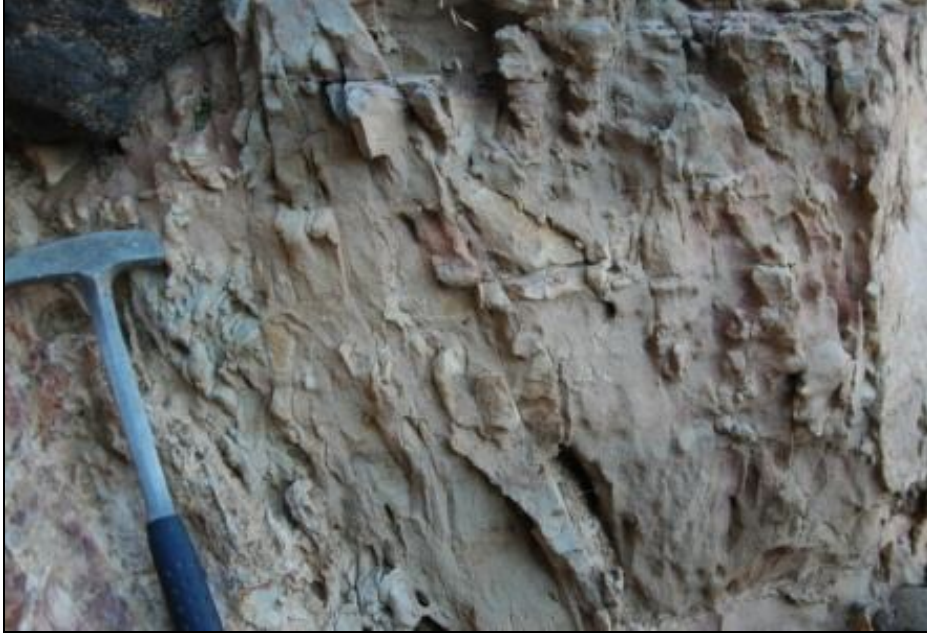
Şekil 5.33. Kuvvetli asit etkisiyle karbonatlı kayalarda, karbonat boşalmasıyla meydana gelen dekalsifikasyon (kumlaşma).
