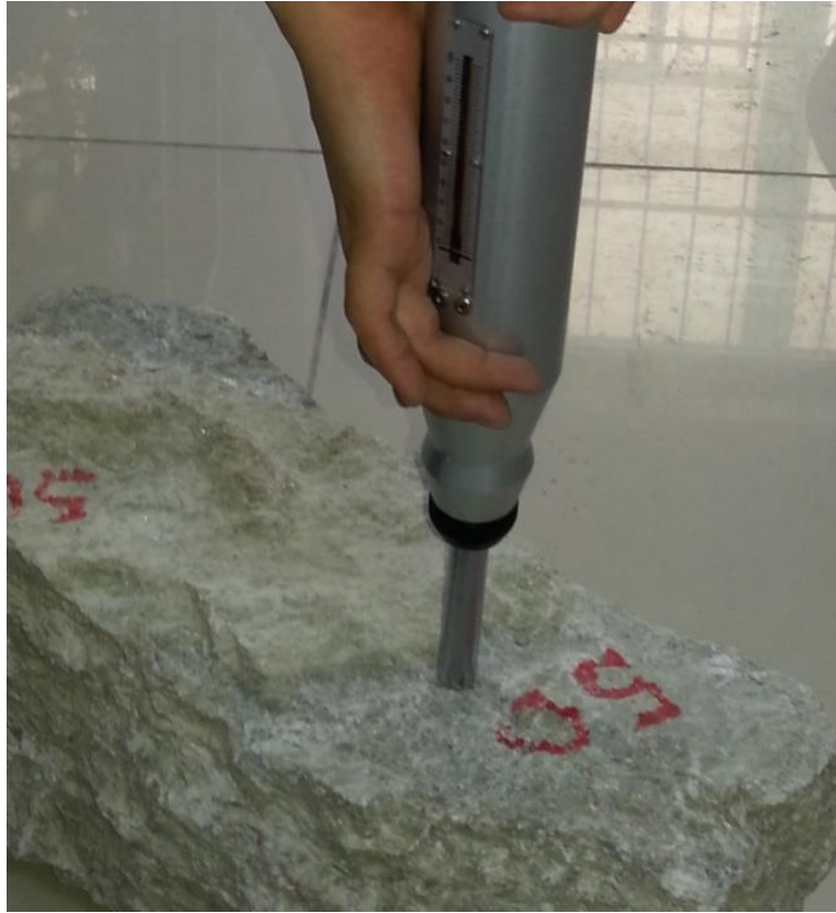
Şekil 3.4. Schmidt Çekicinin kaya bloklar üzerinde uygulanması.
