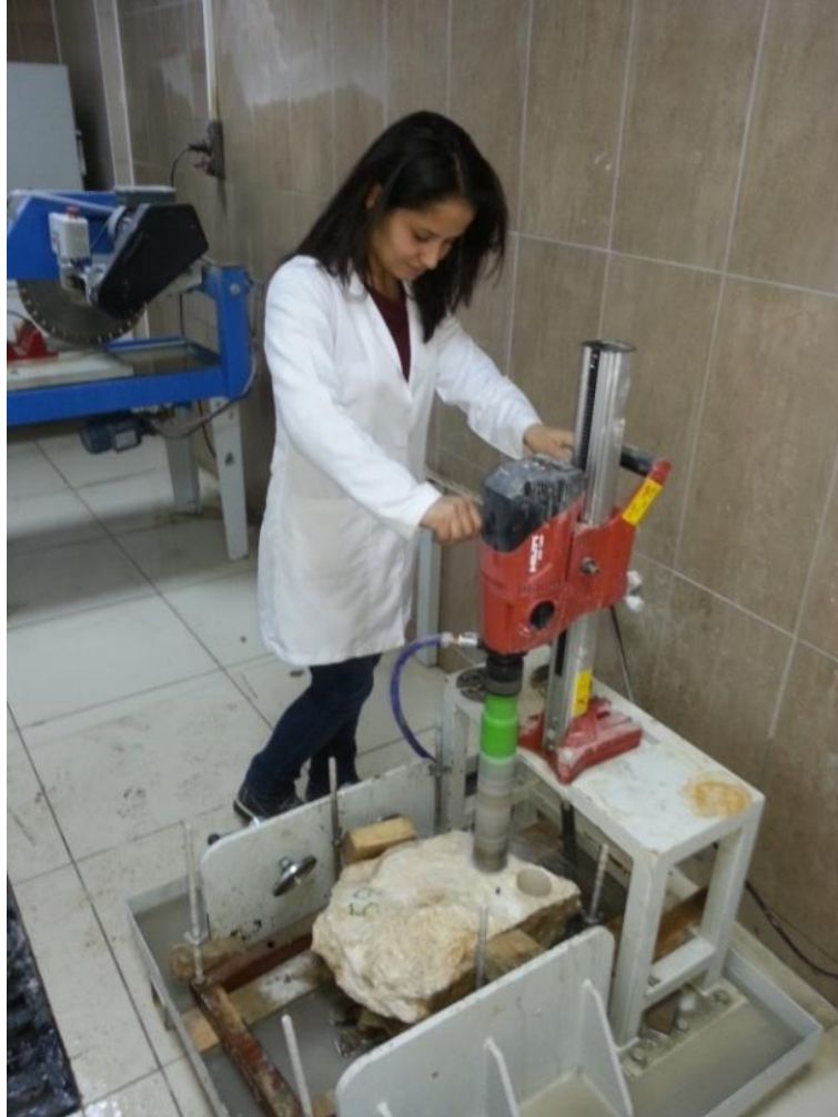
Şekil 3.5 Karot örneklerin elde edilmesi.
