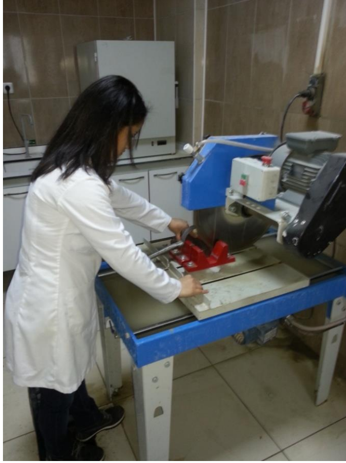
Şekil 3.6 Karot örneklerinin alt ve üst yüzeylerinin düzeltilmesi.
