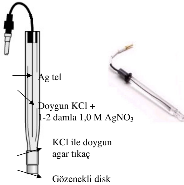
Şekil 3.2. Gümüş-gümüş klorür referans elektrot
