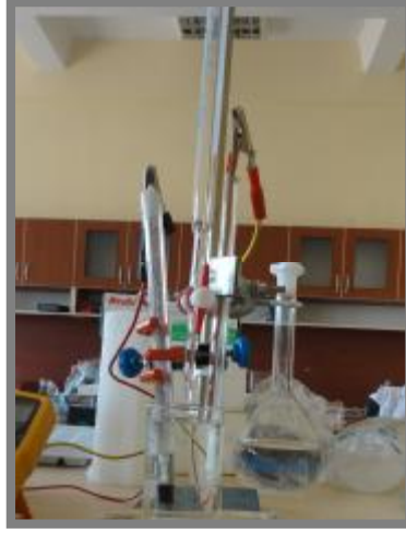
Şekil 3.5 : Ayrışma gerilimi belirleme düzeneği
