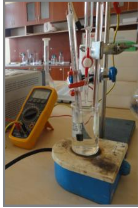
Şekil 3.2: C yüzeyine Pt çöktürme düzeneği
