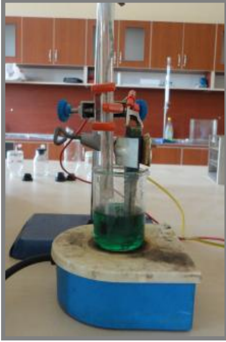
Şekil 3.1: C yüzeyine Ni kaplama düzeneği
