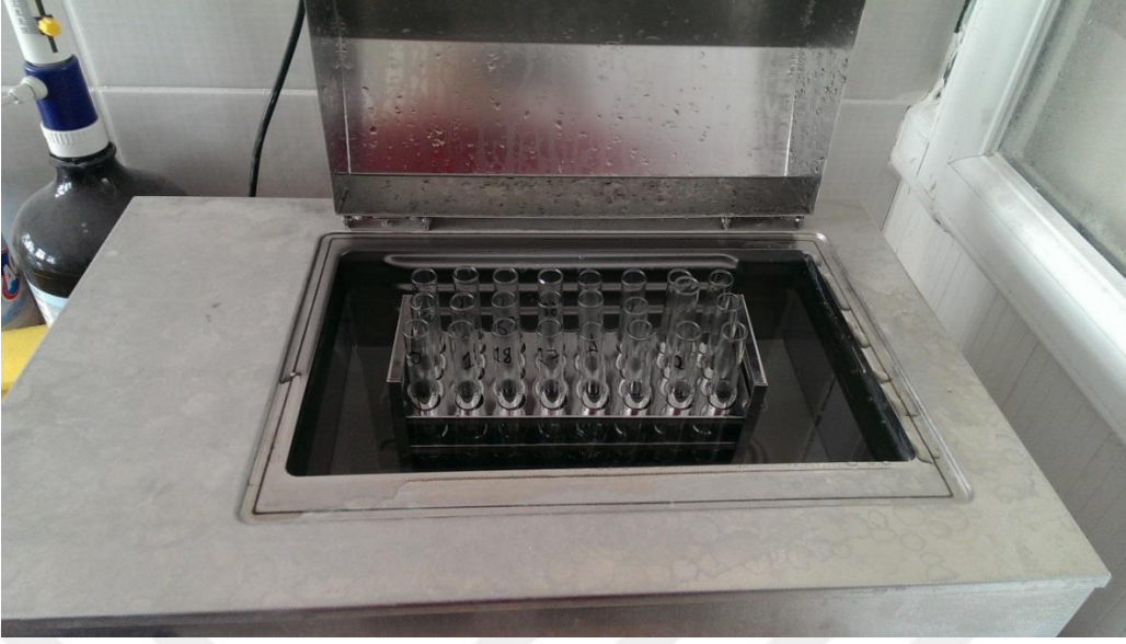
Şekil 3.6. İletkenlik ölçümü için su banyosu
