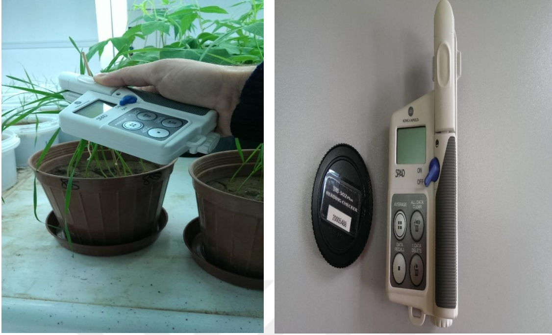
Şekil 3.8. SPAD metre ile klorofil miktarının belirlenmesi
