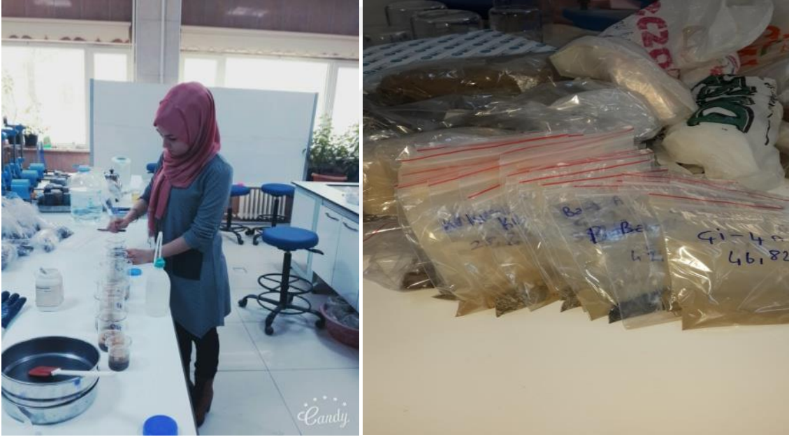
Şekil 3.4. rneklerden laboratuvarında kum ve silt-kil fraksiyonlarının ayrılarak XRD ve kimyasal analizler için hazırlanması.
