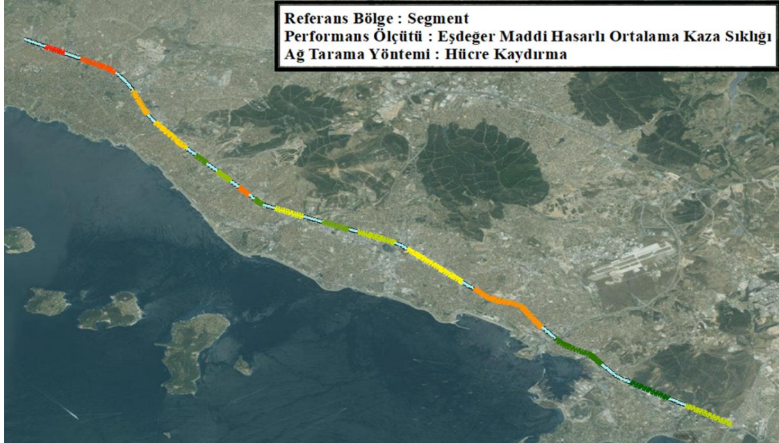
Şekil 4.13. Segment referans bölgesinin EMH ortalama kaza sıklığı performans ölçütüne göre hücre kaydırma yöntemi sonuçları.
