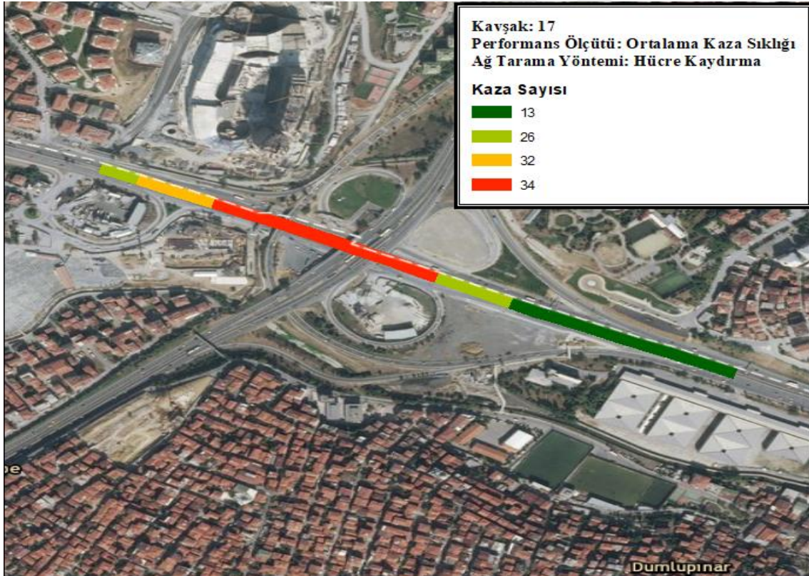
Şekil 4.12. 17 no'lu kavşağın ortalama kaza sıklığı performans ölçütüne göre hücre kaydırma yöntemi sonuçları.
