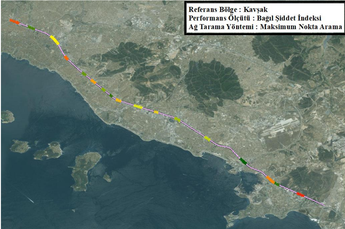
Şekil 4.32. Kavşak referans bölgesinde bağıl şiddet indeksi performans ölçütüne göre maksimum nokta arama sonuçları.
