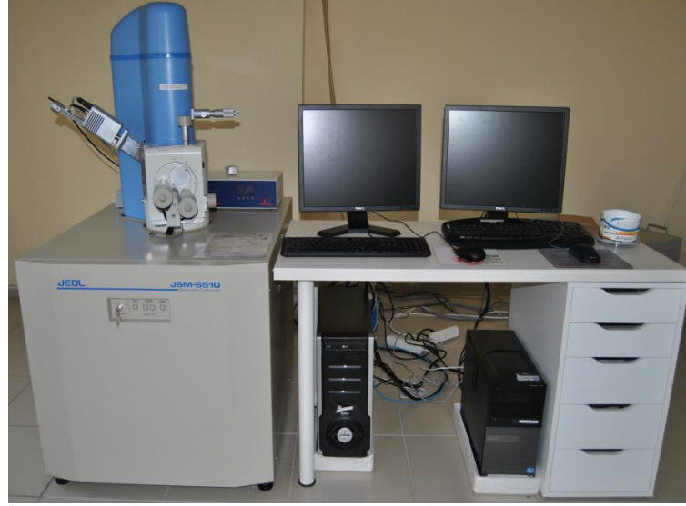
Şekil 3.5. Morfolojik görüntülerin alındığı ve elementel analizlerin gerçekleştirildiği SEM/EDX sistemi
