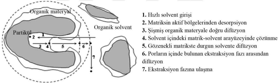
Şekil 1.18. Organik bir solvent tarafından sarılan bir toprak veya sediment partikülünün geliştirilmiş bir modeli için PLE'de ekstraksiyon basamakları.
