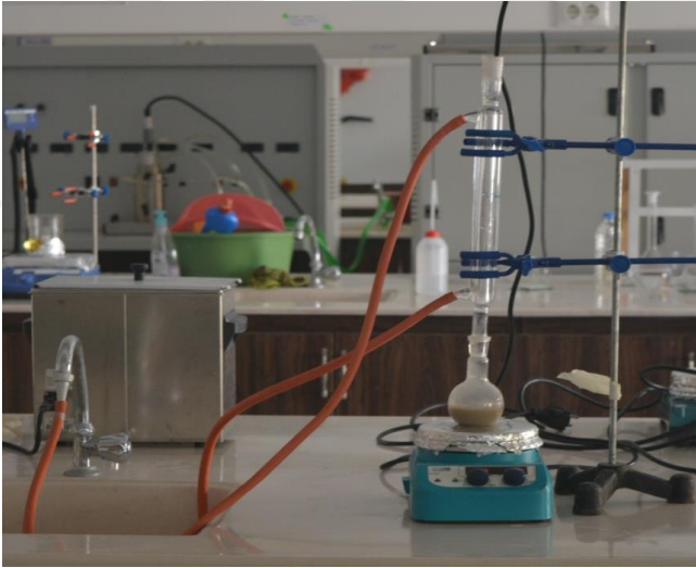
Şekil 3.2. Bentonitin modifikasyon işlemi düzeneği.
