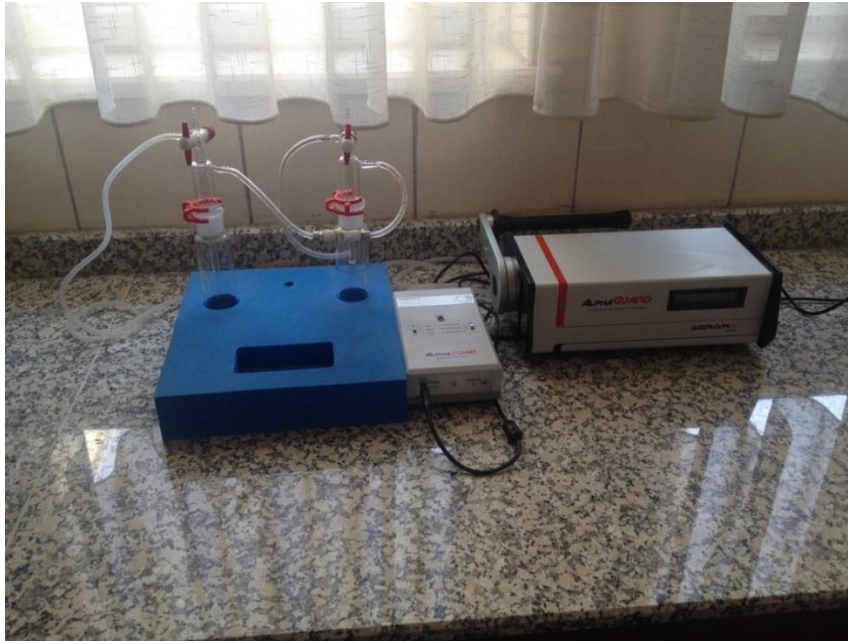
Şekil 4.10. Sudaki radon ölçüm düzeneği
