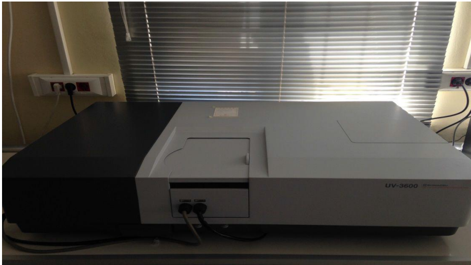
Şekil 3.10. Laboratuvarımızdaki Shimadzu UV-3600 UV-VIS-NIR Spektrofotometre
