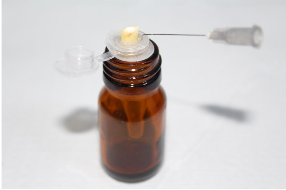
Şekil 14. Örneklerin yerleştirildiği taşma modeli
