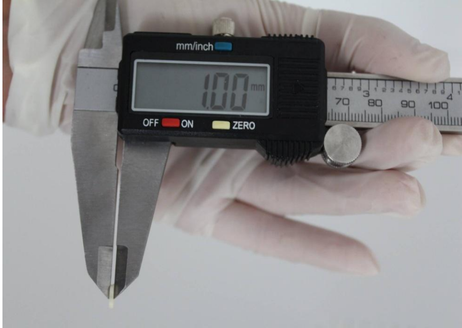
Şekil 31. Kesit kalınlıklarının digital kumpasla ölçülmesi
