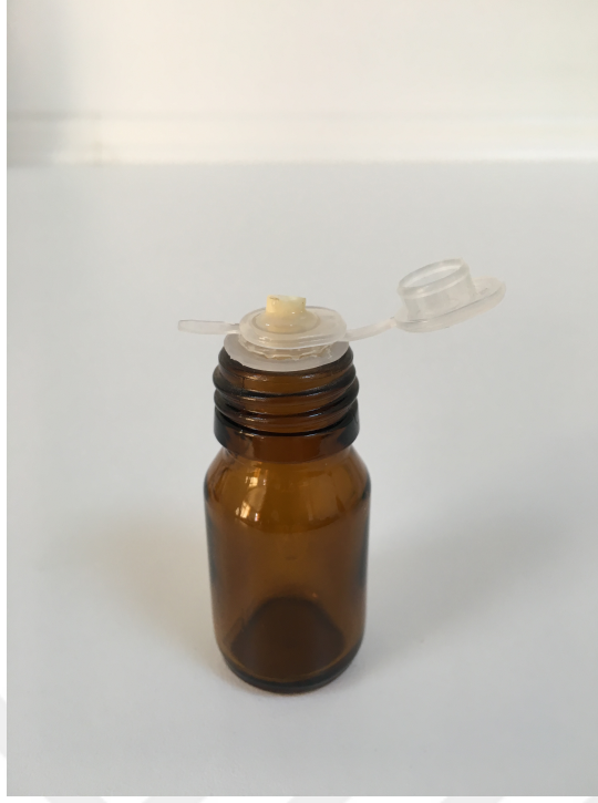
Şekil 6. Eppendorf tüpünün koyu renkli cam şişeye sabitlenmesi
