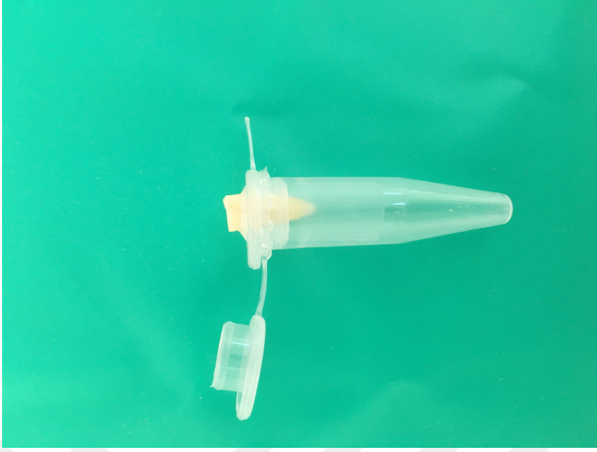
Şekil 5. Eppendorf tüpten kesilmiş kapağın içine örnek dış monte edilmesi ve bu kapağın daha önceden tartılmış eppendorf tüpe kapatılması
