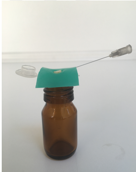
Şekil 7. Düzeneğe 27 gauge'luk enjektör iğnesi ve rubber dam uygulanması
