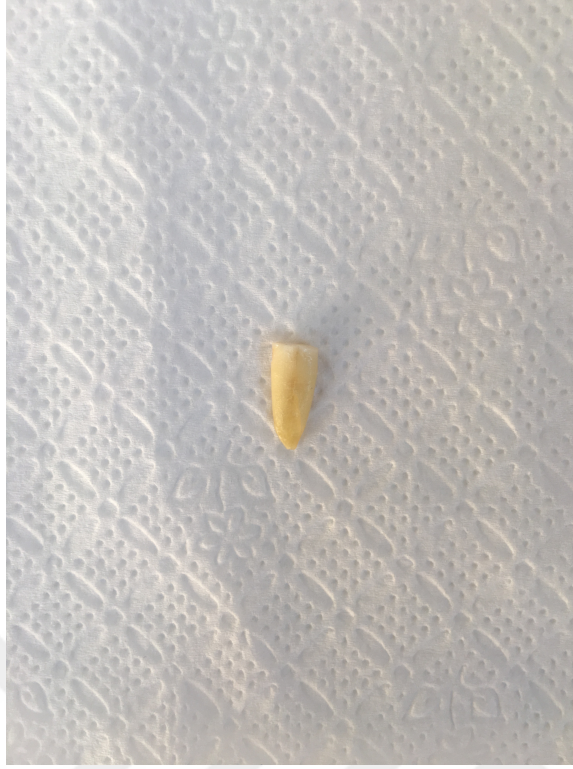
Şekil 4. Deney düzeneğine yerleştirilecek olan örnek dişin kural kısmının kesilerek 11 mm olacak şekilde boyunun ayarlanmış hali
