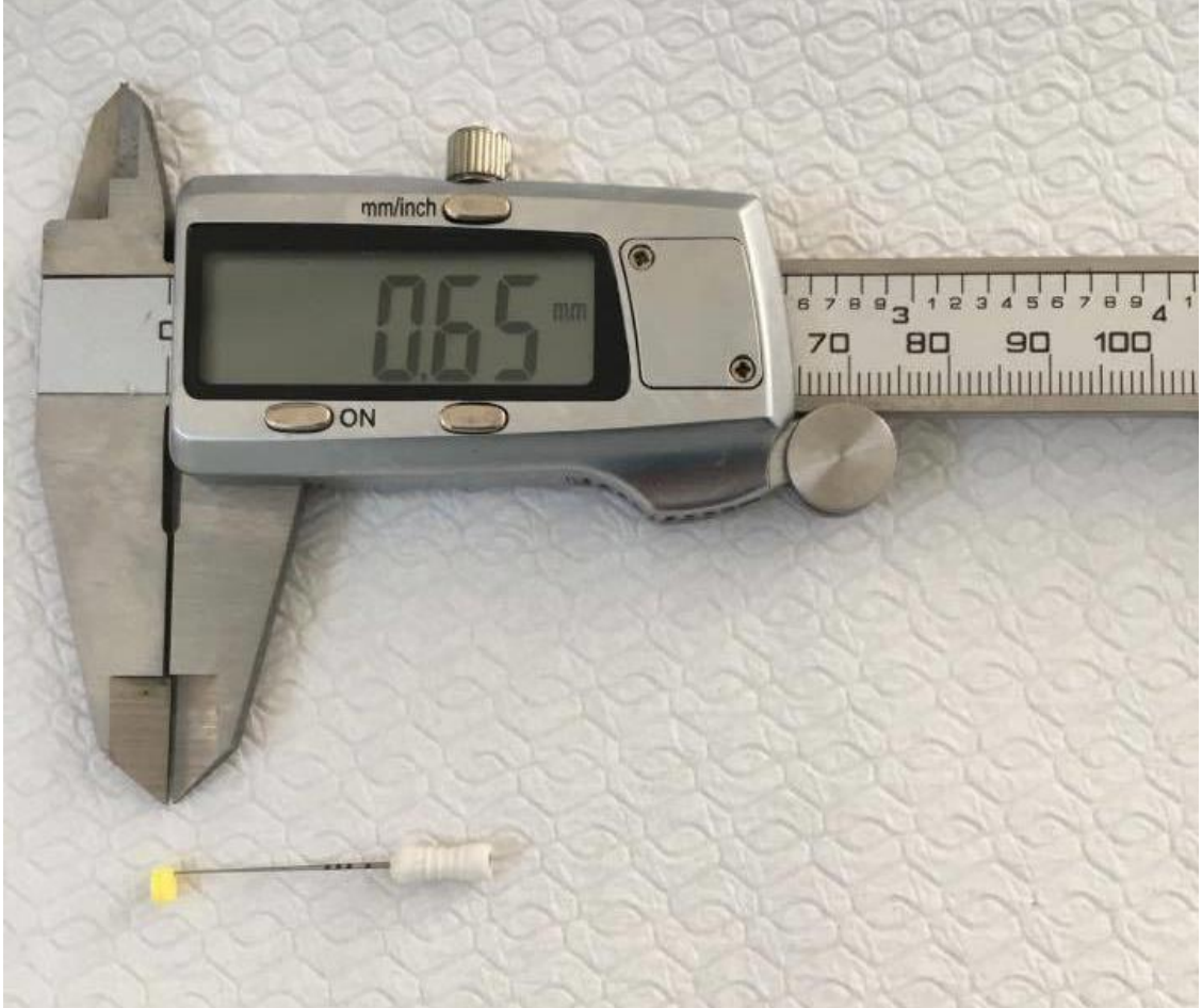
Resim 2. 0.01 mm hassasiyete sahip dijital kumpas ve 10'luk endodontik spreader
