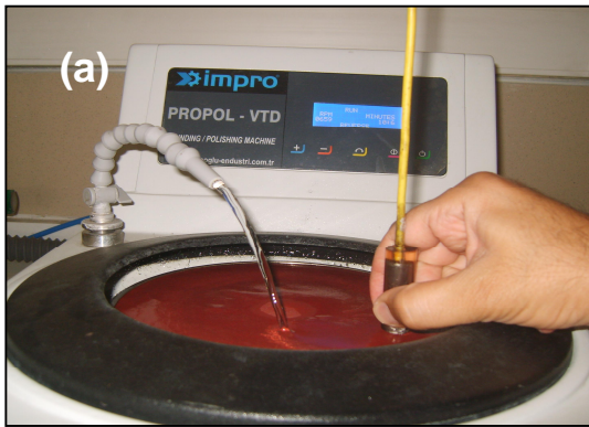
ekil 3.3. YÇ elektrotların mekanik parlatılmasında parlatılması, (a) ve üç elektrot sistemi ile elektrokimyasal ölçümlerin alınması, (b)
