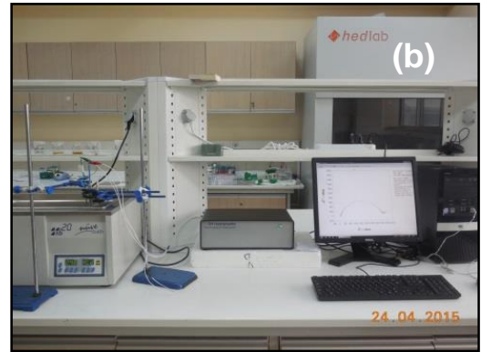
ekil 3.3. YÇ elektrotların mekanik parlatılmasında parlatılması, (a) ve üç elektrot sistemi ile elektrokimyasal ölçümlerin alınması, (b)
