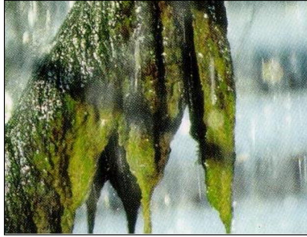
Resim 1.7. Biyolojik korozyona uğramış metal su deposu (URL-7 2015)
