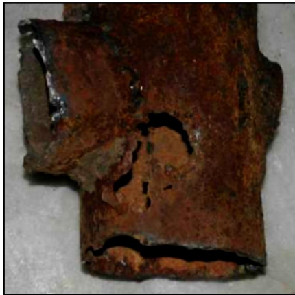
Resim 1.6. Çukurcuk korozyonuna uğramış su borusu (URL-6 2015)
