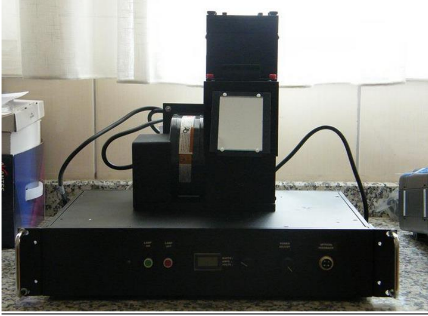
Şekil 3.2. Ayarlı solar simülâtör seti.
