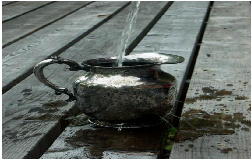
ekil 1.6. ukurcuk korozyona u ram, srahi (URL-6 2016)
