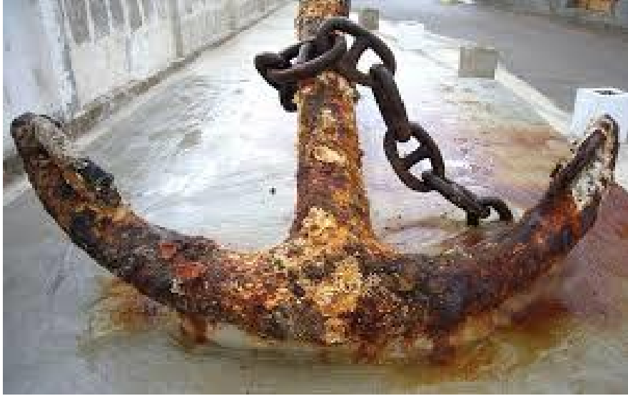
Resim 1.1. Homojen korozyona uğramış çapa (URL-1 2016)
