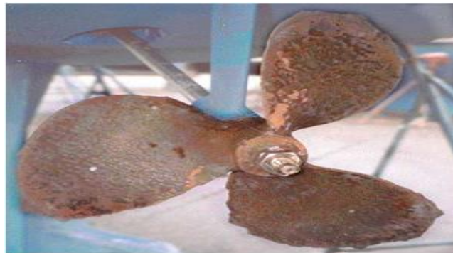
Resim 1.2. Galvanik korozyona uğramış gemi pervanesi (URL-2 2016)
