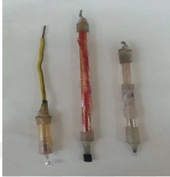
Şekil 3.1. Kullanılan elektrotlar sırasıyla platin, karbon keçe geçirilmiş elektrot, elektrokimyasal ölçümlerde kullanılan elektrot görüntüleri
