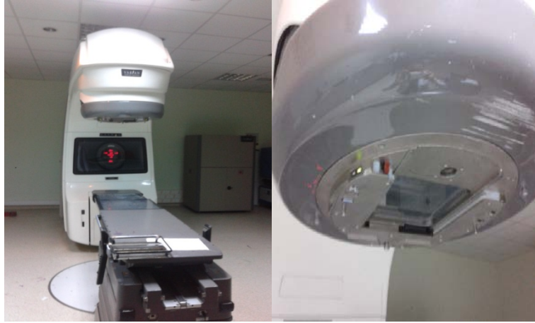
Şekil 3.5. Varian marka Clinac DHX model linak cihazı ve cihaza ait gantry bölümü (kolimatörün ve MLC' lerin bulunduğu bölüm)
