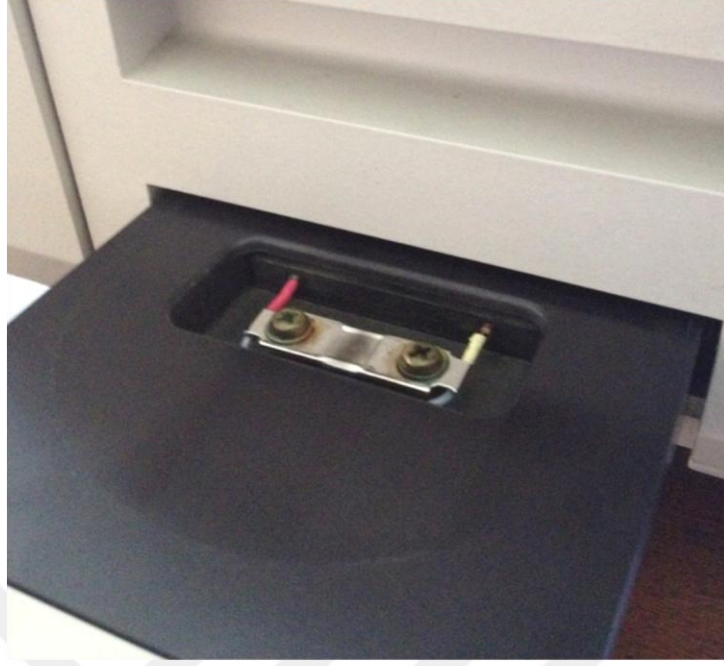
Şekil 3.10. Harshow-3500 TLD Okuyucusuna TLD' lerin yerleştirildiği bölme
