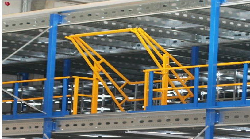
Şekil 2.8. Aktarma geçişli palet kapısı (swingover pallet gate).
