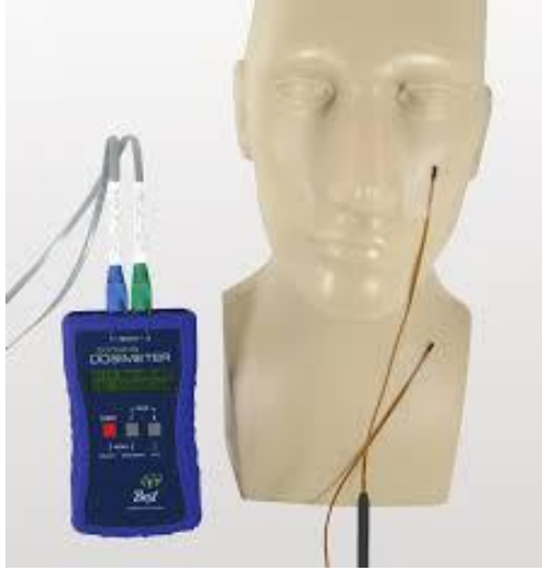
Şekil 3.6. Best Medical Canada marka TN-RD-90 model MOSFET cihazının cilt dozu ölçümünde konumlandırılması (43).
