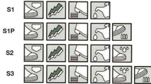
Şekil 2.32. İş ayakkabısının standartlara uygun sınıflandırılması (88,89).
