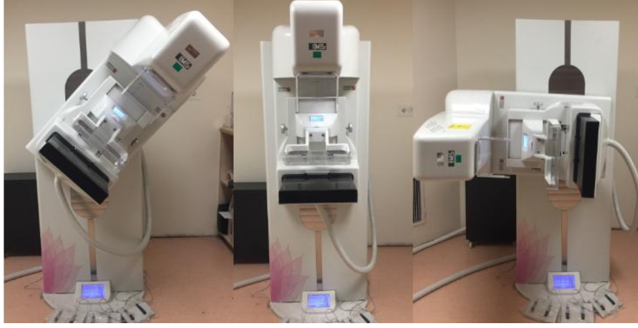
Şekil 2.8. Dijital Mamografi Cihazı Tüpünün Cranial-Caudal Görüntü (CC) Mediolateral Oblik (MLO) ve Lateral Pozisyonu.
