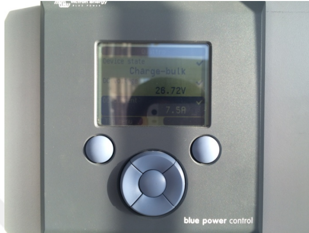
Şekil 48 Şebeke üzerinden yük besleme ve akü bankasının şarj kesim noktasına kadar şarj edilmesi modu
