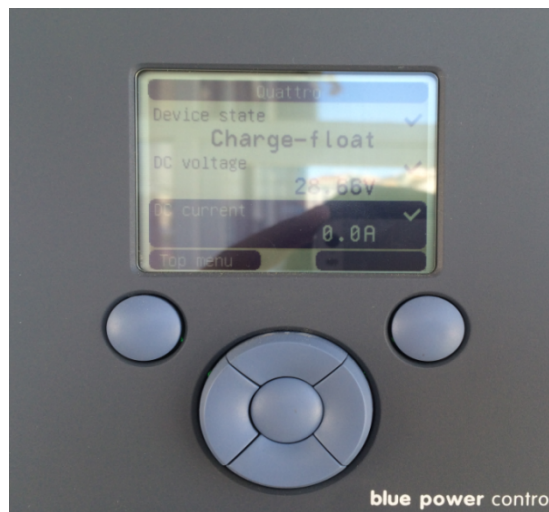
Şekil 46 Şarj kesim ve yük besleme modu
