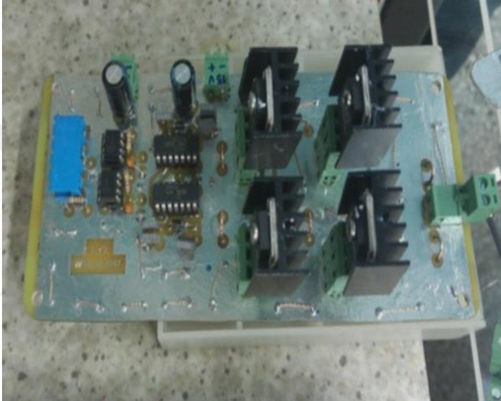
Şekil 4.13 DA/AA dönüştürücü devre kartı
