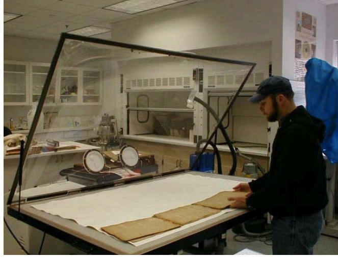
Resim 54: Isı masasına resimlerin yerleştirilmesi.
