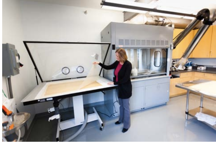
Resim 56: Sıcak masada resmin astarlanması.
