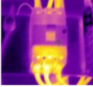
Şekil 5.5. Anahtar ve rölelerdeki aşırı ısınmaların tespiti
