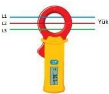
Şekil 7.4. Üç fazlı besleme için ölçüm yöntemi
