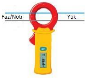
Şekil 7.3. Tek fazlı besleme için ölçüm yöntem
