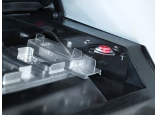
Şekil 3-2: EmbryoScope® inkübatörünün iç görüntüsü; arka planda fotoğraf çekme özelliğine sahip lens ve kırmızı ışığı, ön planda embriyoların yerleştirildiği özel slayt ve yuvaları.
