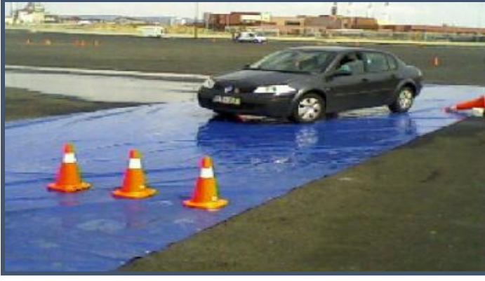
Resim -12- Suni olarak oluşturulan Kaygan yolda yol hakimiyeti testi
