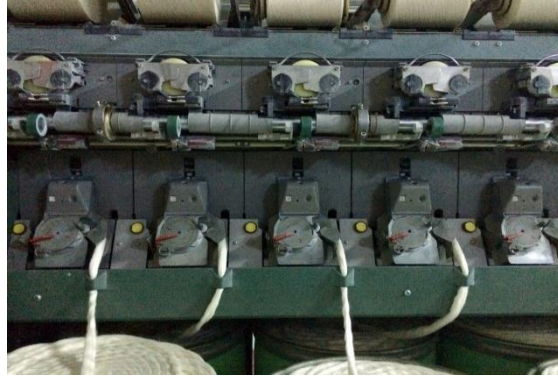
Şekil-25. Open-End İplik Makinesi Eğirme Elemanları
