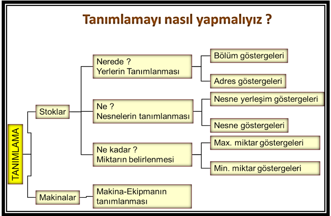
Şekil 4 : 5S Yöntemi düzenleme işleminin nasıl yapılacağı haritası
