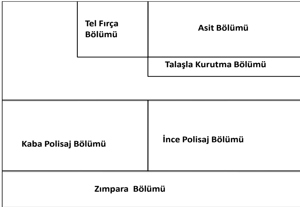
Şekil 6 : İşletmedeki metal yüzey temizleme bölümünün görünümü.
