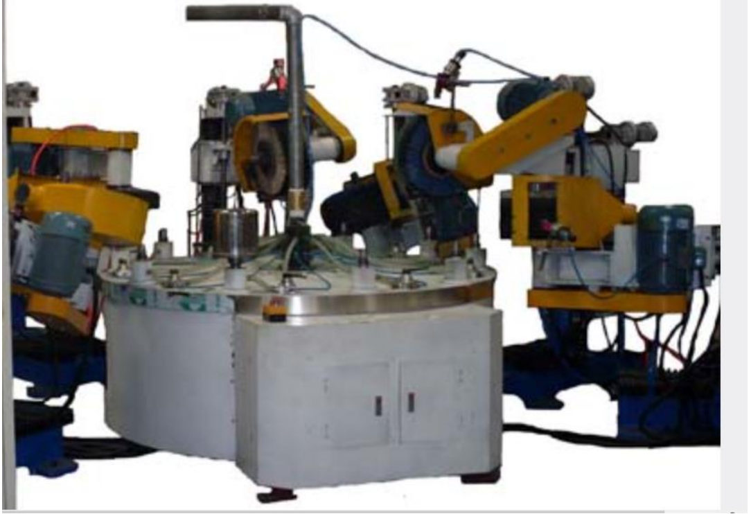
Resim 33 : Otomatik çaydanlık dış ince polisaj makinesi.[29]
