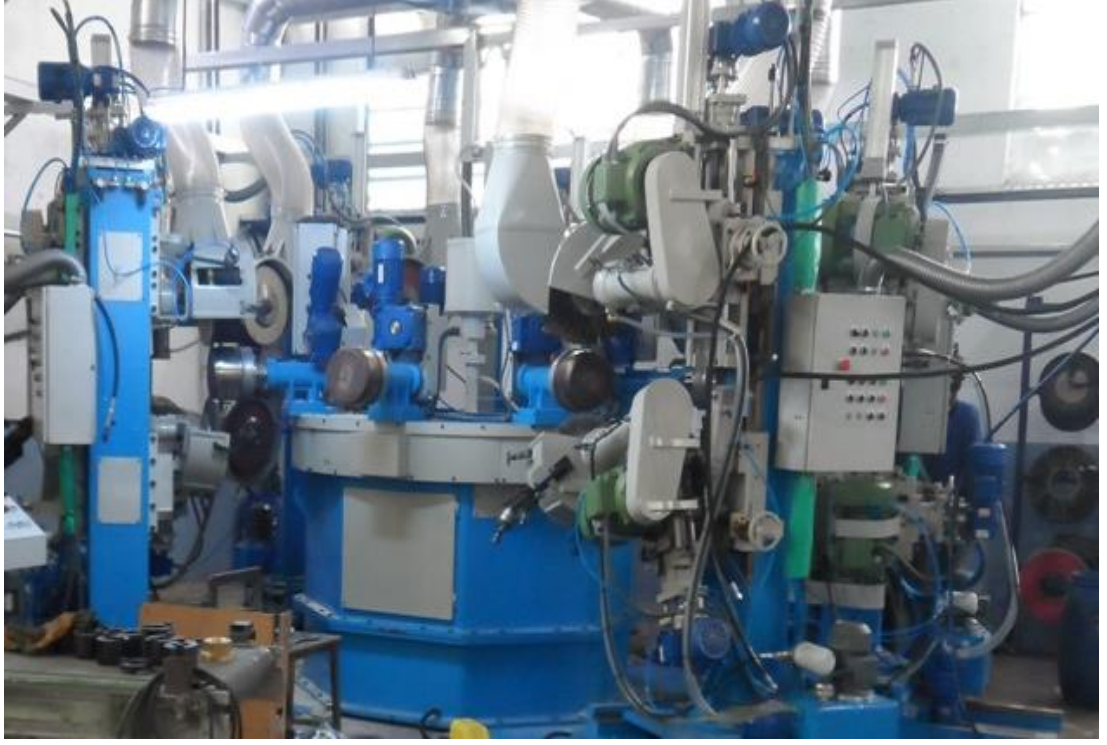
Resim 32 : Otomatik çaydanlık dış kaba polisaj makinesi.[28]
