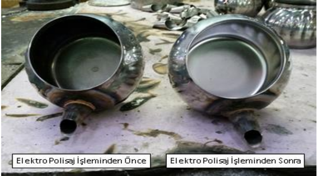
Resim 16 : Elektro polisaj işlemi.
