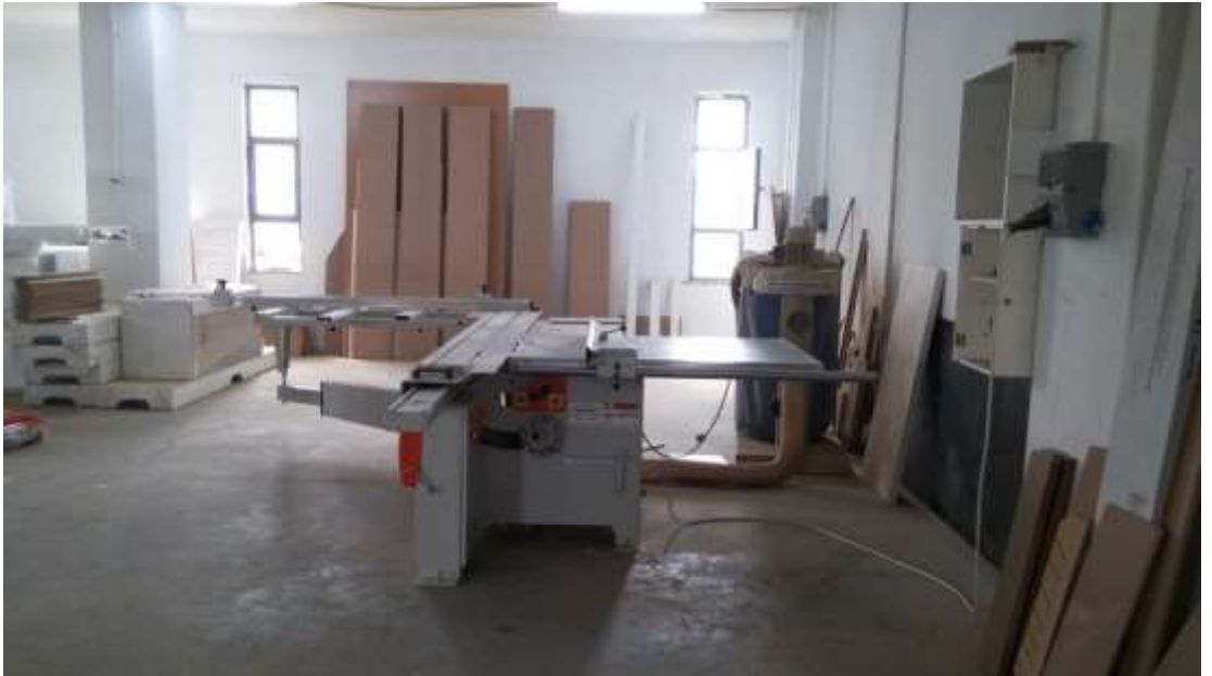
Resim 29 : Tüm iş makinalarının etrafında çalışmaya engel eşya yok
